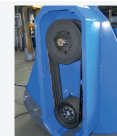
Trasmissione con pulegge di grandi dimensioni
